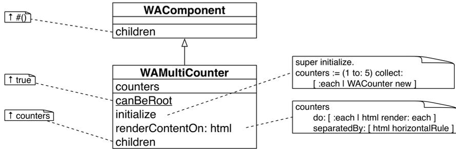
FIGURE 12.9 – L’application de compteurs multiples “multicounter” basée sur la classe WAMultiCounter.
