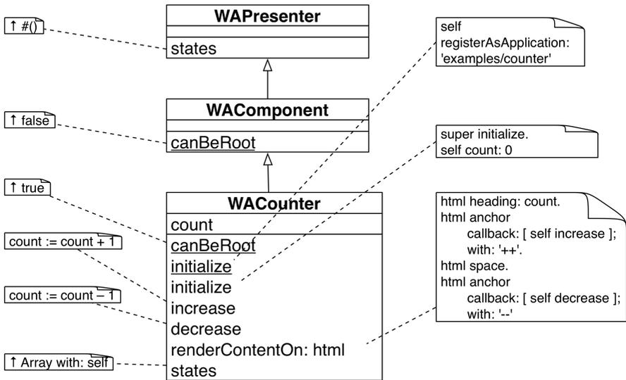
FIGURE 12.8 – La classe WACounter implémentant l'application “counter”. Les méthodes avec les noms soulignés sont des méthodes de classe ; les autres sont des méthodes d'instance.
