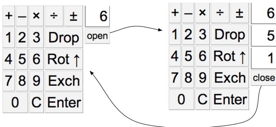
FIGURE 12.15 – La calculatrice RPN et sa machine à pile.
