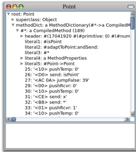
FIGURE 14.5 – L’explorateur de la classe Point et le *bytecode* de sa méthode #\*.
